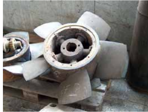
Hélice endommagée d'une pompe
