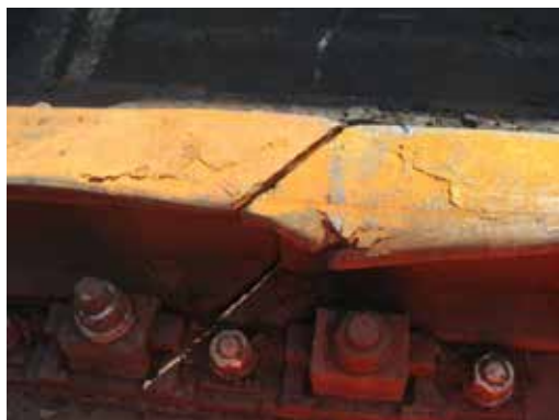
Autres exemples de dégâts aux rails
